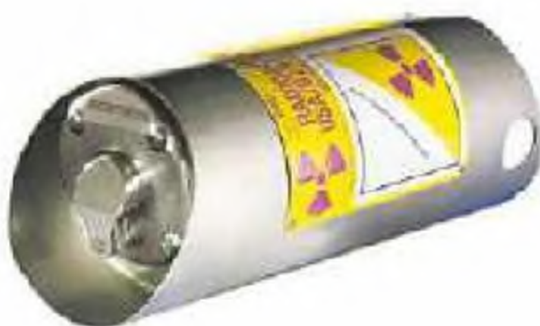
VUE AVANT PORT DE SORTIE CONNECTEUR DU GUIDE TUBE
