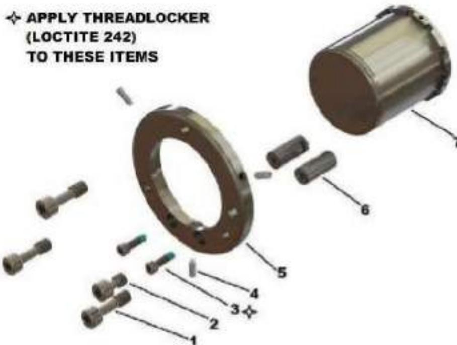
Figure 16 – Vue éclatée des composants de l'assemblage du collimateur
