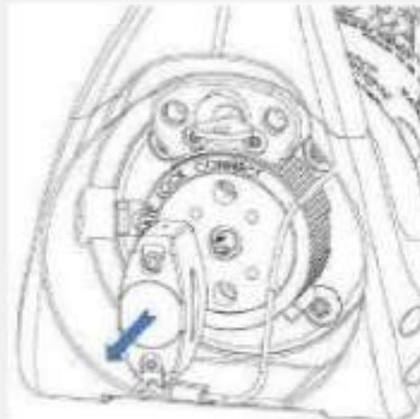
5. Faites glisser le collier du connecteur de sécurité 661 vers l'arrière pour ouvrir les mâchoires et accéder au connecteur du câble de commande.
