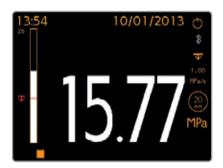
Testeur d'adhérence automatique avec des échelles de traction sélectionnables pour des plots de diamètre 10; 14,2; 20 et 50mm.
