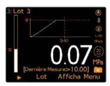
Possibilité d'appliquer la traction jusqu'au maximum ou bien une limite prédéfinie. La fonction de limite de temps permet aux utilisateurs de définir un délai avant le retour de la pression à zéro.
