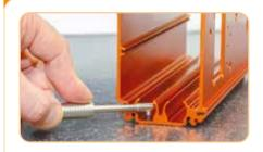
Précisiona: ±1-3% ou ±2,5µm ±1-3% ou ±0,1mil Plage de mesures: 0-500µm 0-20mils Résolution: 0,1μm: 0-100μm 0,01mil: 0-5mils 1μm: 100-500μm 0,1mil: 5-20mils Certificat:
