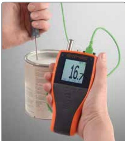
Te - idéal pour une utilisation en simple thermomètre
