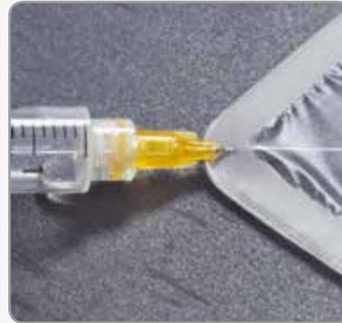
Les nouveaux patches pour test de Bresle Elcometer 135C ont un contour en mousse plus épais par rapport aux patches traditionnels, ce qui permet d’insérer plus facilement la seringue.
