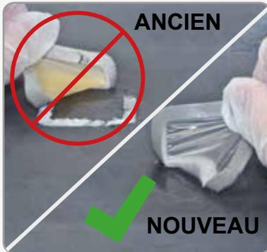
Les patches pour test de Bresle Elcometer 135C sont faciles à décoller après l’essai; ils ne laissent aucune trace de mousse sur le substrat et évitent les dommages liés au nettoyage de la surface (grattage).
