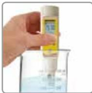
Doté d'un capteur en forme de coupe, le conductivimètre Elcometer 138E peut mesurer la conductivité d'une solution à partir de quelques gouttes seulement.
