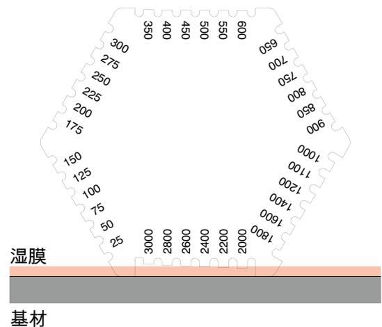
在所示的示例中，湿膜厚度在2400 $\mu\text{m}$ 和2600 $\mu\text{m}$ 之间。
