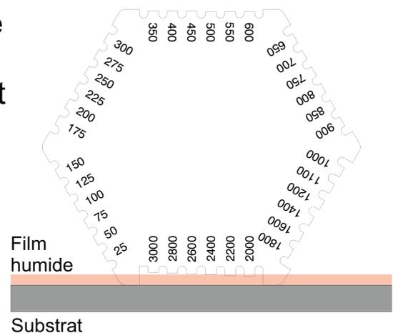
Dans l'exemple illustré, l'épaisseur de film humide se situe entre 2400  $\mu\text{m}$  et 2600  $\mu\text{m}$ .
