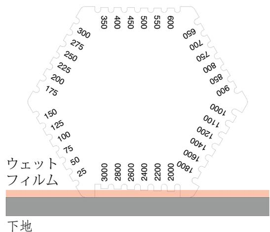
この例では、ウェットフィルムの厚さは、 $2400\mu\text{m}$ と $2600\mu\text{m}$ の間になります。
