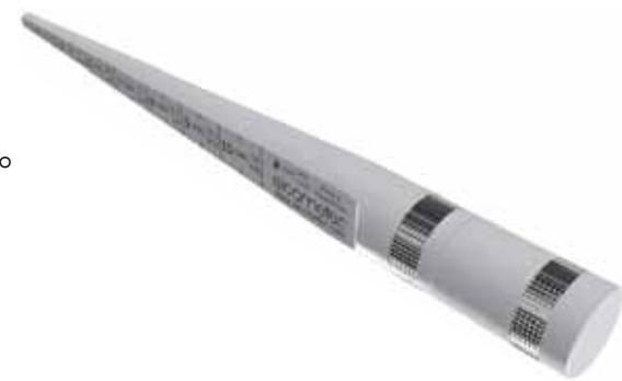
ゲージの正しい使用により、噴出圧力の低下やベンチュリ効果の低下などの原因になるオリフィスの摩耗状態を知る事ができます。
