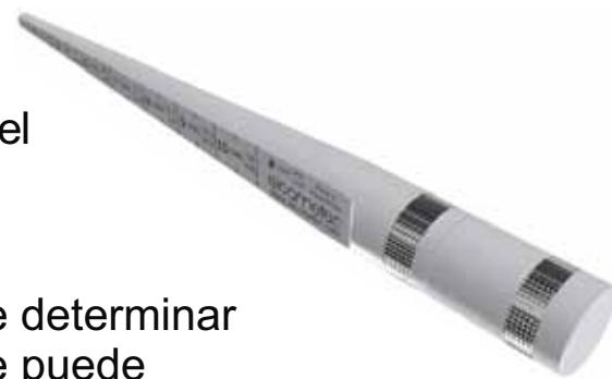
Un uso adecuado de este medidor permite determinar el desgaste del orificio de una boquilla que puede provocar una presión baja de la boquilla y una menor eficiencia en el rendimiento del venturi de la boquilla.
